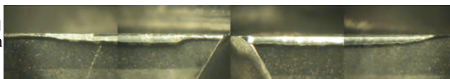
Фреза компании YG-1 (Общая длина фрезерования 140 м)
