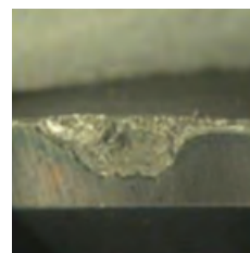
Фреза производителя А (Общая длина фрезерования: 210 м)
