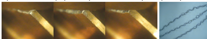
Производитель А (Нарезание резьбы в 330 отверстиях) - Спираль
