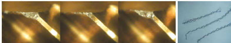
YG-1 (Нарезание резьбы в 490 отверстиях) - Спираль
