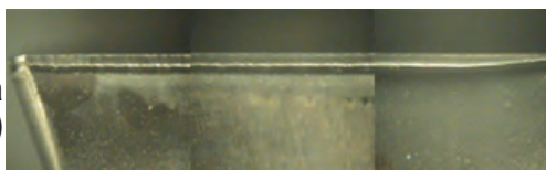
Фреза компании YG-1 (Общая длина фрезерования 140 м)
