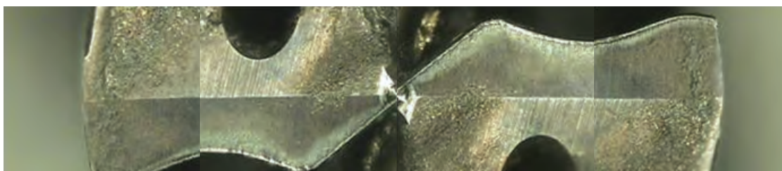
Сверло производителя А (после 546 отверстий)
